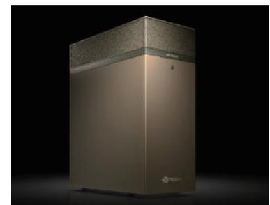
最新GPU「TESLA V100」×4基や第2世代のNVLink、新しいTensorコアアーキテクチャを搭載し、混合制度演算性能は500TeraFLOPSに達する個人向けスーパーコンピュータ。デスク下に収まる省スペースサイズで、水冷システムによる静粛性や優れた低消費電力性能も兼ね備える。
